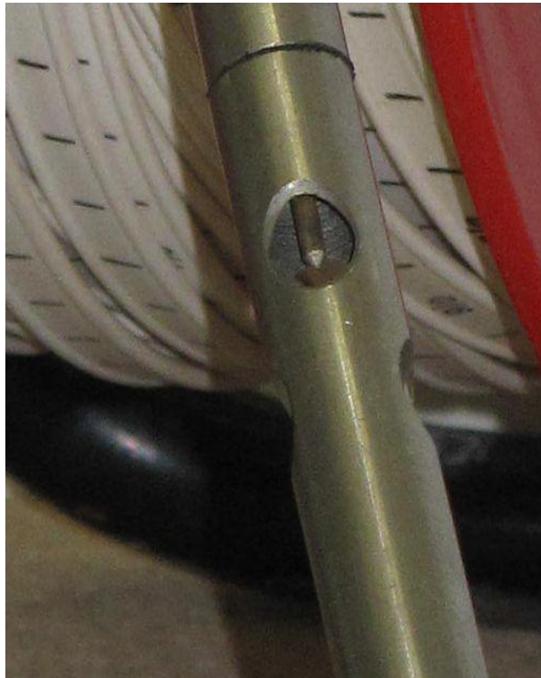
Figur 4. Manuelt pejler, hvor pejlet giver et signal, når der løber en strøm mellem de to elektroder i pejlet. Dette sker, når der er elektrisk ledende vand mellem elektroderne, se billedet til højre. NB. Der kan ske fejl, hvis vandet stammer fra kondens på forerøret. Grundvand med lav ledningsevne vil kun lede en mindre strøm, hvilket svækker signalstyrken.
