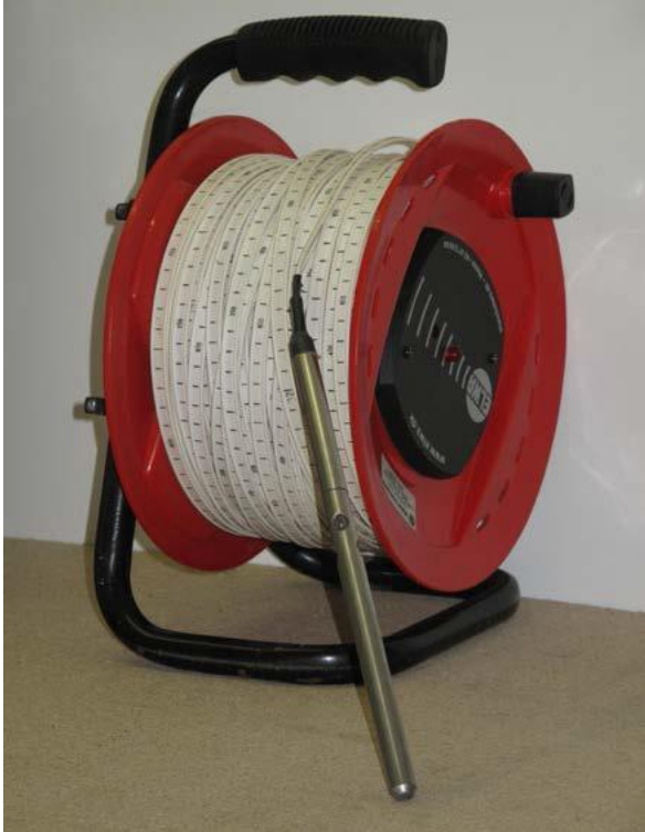
Figur 4. Manuelt pejler, hvor pejlet giver et signal, når der løber en strøm mellem de to elektroder i pejlet. Dette sker, når der er elektrisk ledende vand mellem elektroderne, se billedet til højre. NB. Der kan ske fejl, hvis vandet stammer fra kondens på forerøret. Grundvand med lav ledningsevne vil kun lede en mindre strøm, hvilket svækker signalstyrken.
